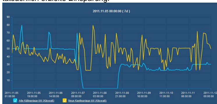
Abbildung 62: Optimierung einer Kälteanlage (Wochenansicht)
