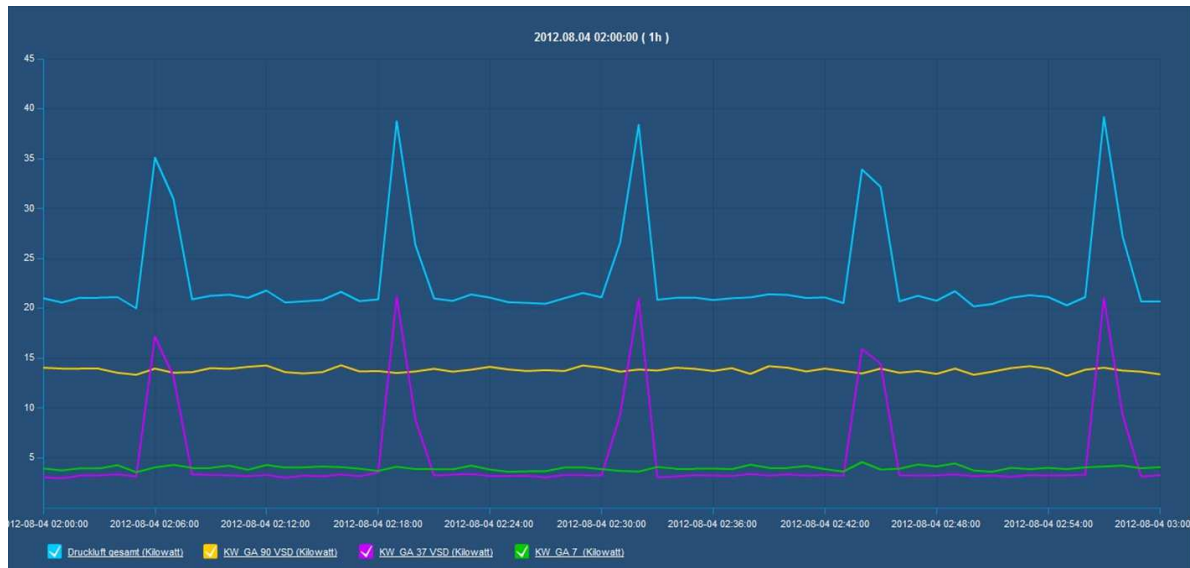
Abbildung 65: Lastverlauf der Druckluftanlage nach den Effizienzmaßnahmen
